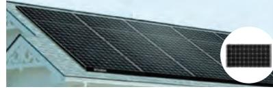
三菱PV-MA2120J（単結晶）効率的に太陽光から電気をつくる4本バスバーの実用化により出力がアップ。バス線本数をこれまでの2本から4本に増やすことで電気抵抗を低減し、セル1枚あたりの出力が従来品に比べて向上しました。
