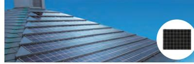
太陽電池セルの表面にプラズマと反応性ガスでミクロン単位の微細な凹凸層をつくり反射ロスを抑える「d.Blue®」技術を確立。さらに太陽電池セルを雨やホコリから守る表面ガラスを特殊加工し光の透過率を高め反射ロスを抑える「低反射力パーガラス」も新採用。W効果で高い発電量を発揮します。
